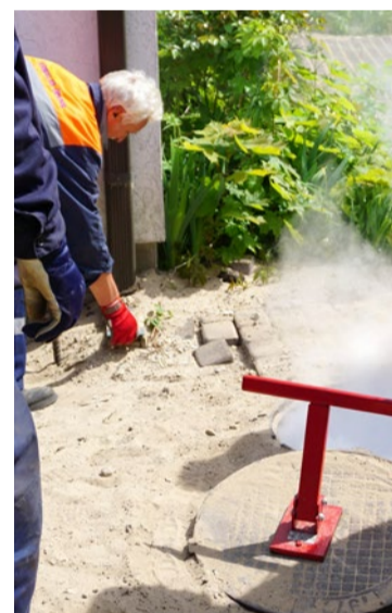
Ar dūmu ģeneratoru ātri var noteikt vietas, kur sadzīves kanalizācijas sistēmā tiek novadīti lietus notekūdeņi.
